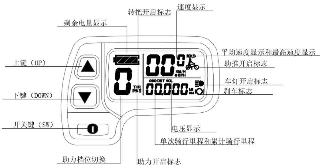
KT-LCD11型仪表面板上设有三键，分别用图符▲键(替代文字UP)、①键(替代文字SW)和▼键(替代文字DOWN)表示。
