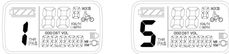
在每次开机时，仪表将自动恢复上次关机时的档位(也可根据用户的要求配置)。当助力比档位为0档时，无助力功能。
