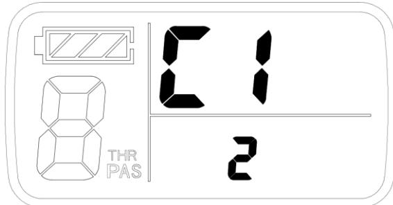
Set C1 parameter first after entering C parameter setting environment, press button, C1 parameter column flashes.
